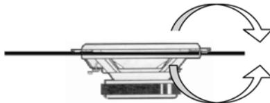
Поверхность, на которую производится установка динамика, должна быть по возможности жесткой и лишенной подвижности. Так, например при установке динамика в дверь, желательно укрепить ее обивку, которая при больших уровнях громкости может породить массу нежелательных призвуков. Все подвижные детали внутри двери (тяги, тросики и т.д.) необходимо по возможности «заглушить».
