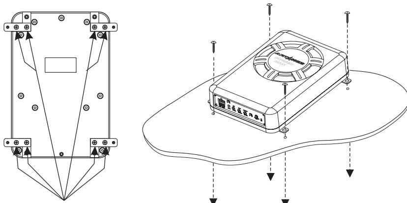
Для установки POWERBOX используйте входящие в комплект пластины, которые можно установить в одном из двух наиболее удобных положений
