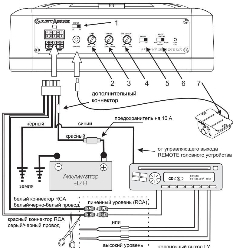
1. INPUT Селектор входного уровня сигнала. При подключении по линейному уровню выбираем LO, при подключении по высокому уровню, выбираем HI.
